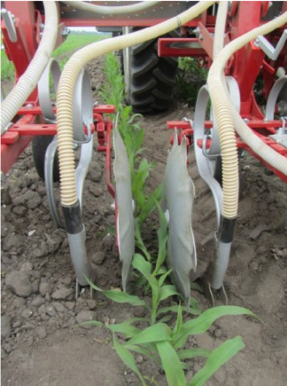
Billede 2. Billedet viser gødningsudstyr, monteret på en radrenser. Gødningen lægges i jorden
